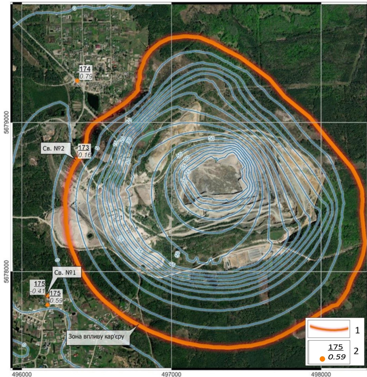
Рис. 6. Карта знижень рівнів водоносного горизонту в тріщинуватій зоні кристалічних порід за результатами моделювання (абсолютна відмітка підшви кар'єру +104 м):
