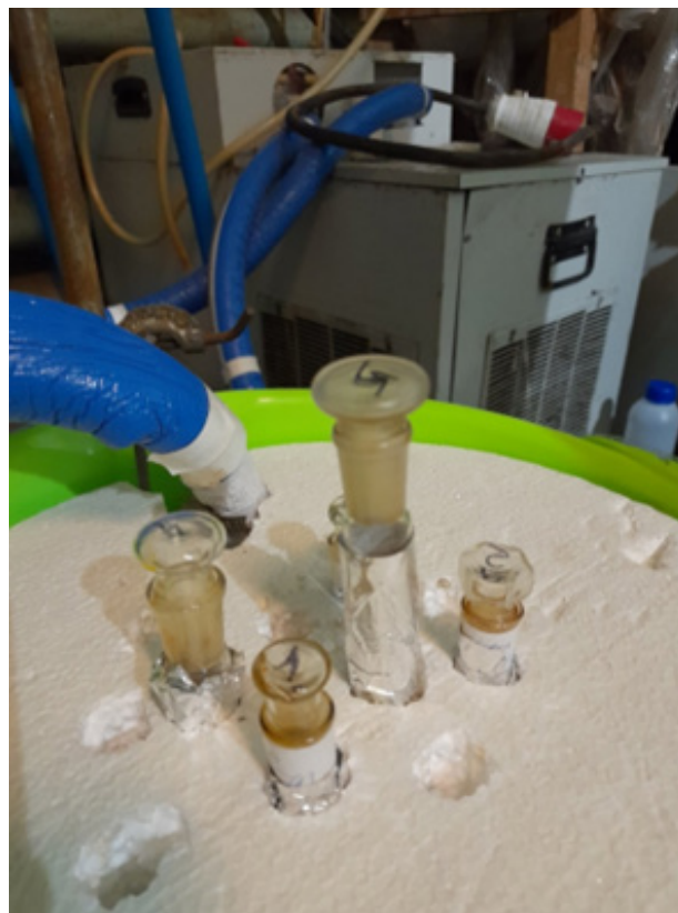
Рис. 1. Термостатовані при -18\text{ }^{\circ}\text{C} реакційні посудини з використанням криостата із зовнішнім охолодженням.
