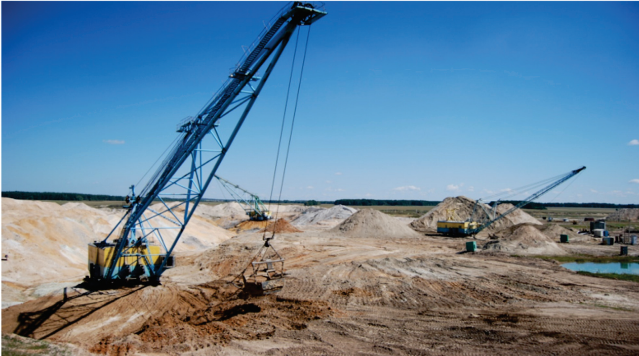
Рис. 4. Промислова розробка розсипних титанових руд Іршанського рудно-розсипного району (Василенко, 2014).
