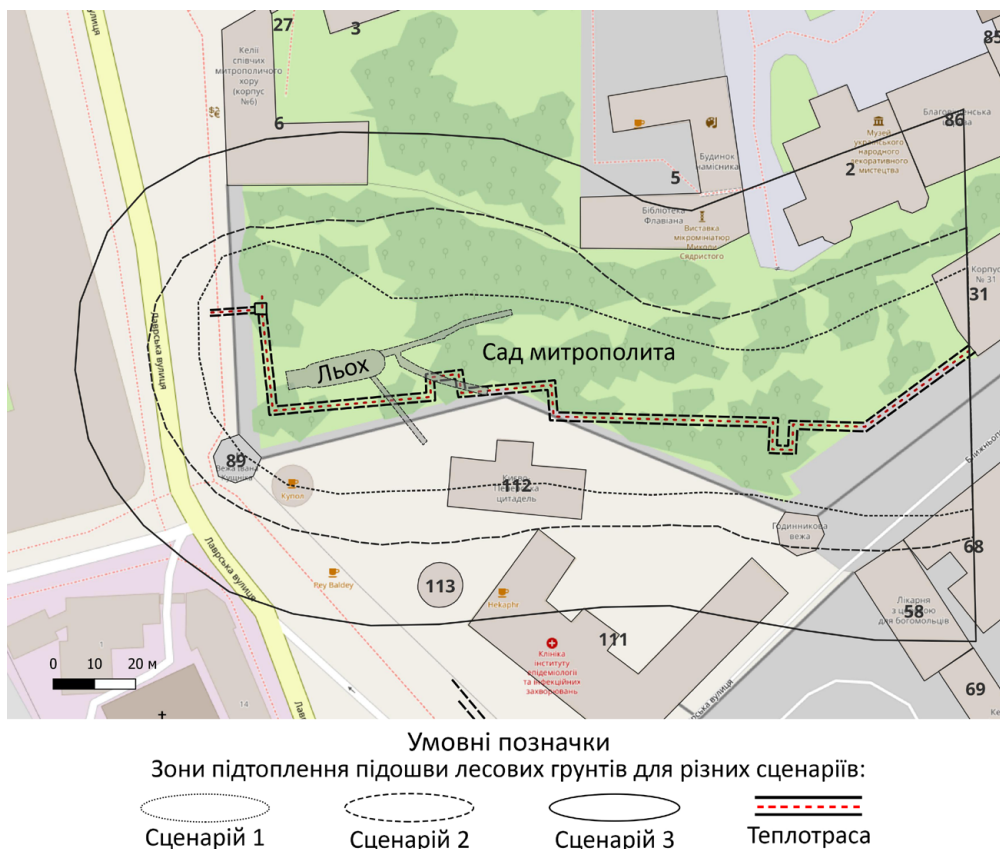
Рис. 12. Прогнозні ділянки підтоплення підшви лесових ґрунтів при аварійних сценаріях 1–3 ( \Delta Z > 0,1 м).
