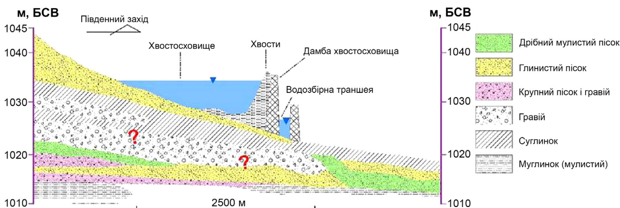
Рис. 2. Геологічний розріз уранового хвостосховища Баян-Обо (Китай) (Huang et al., 2016).
