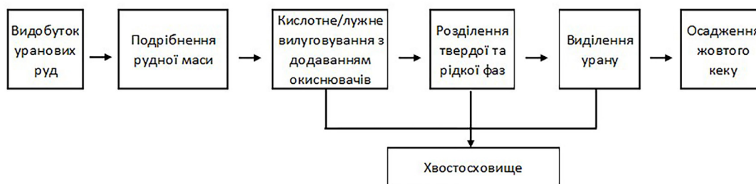
Рис. 1. Блок-схема процесу виробництва уранового концентрату (IAEA, 1992).
