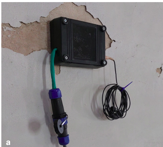
Рис. 6. Фото зразків використаного обладнання: а — акселерометр 66332 AP21 та мікрофон на стіні Успенського собору; б — стандартний сейсмологічний комплект (у корпусі № 3).
