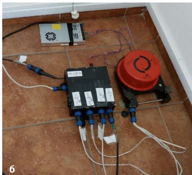
Рис. 6. Фото зразків використаного обладнання: а — акселерометр 66332 AP21 та мікрофон на стіні Успенського собору; б — стандартний сейсмологічний комплект (у корпусі № 3).
